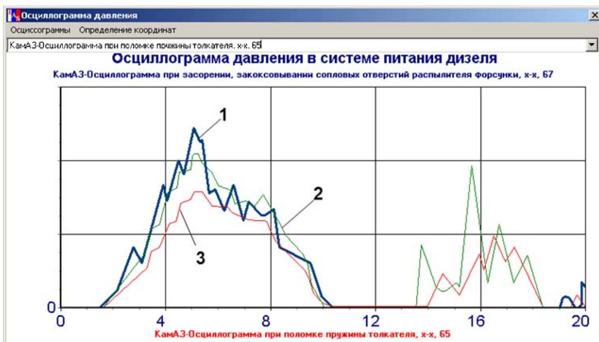
Рис. 7.10. Окно с осциллограммами комплекса KAD-400
