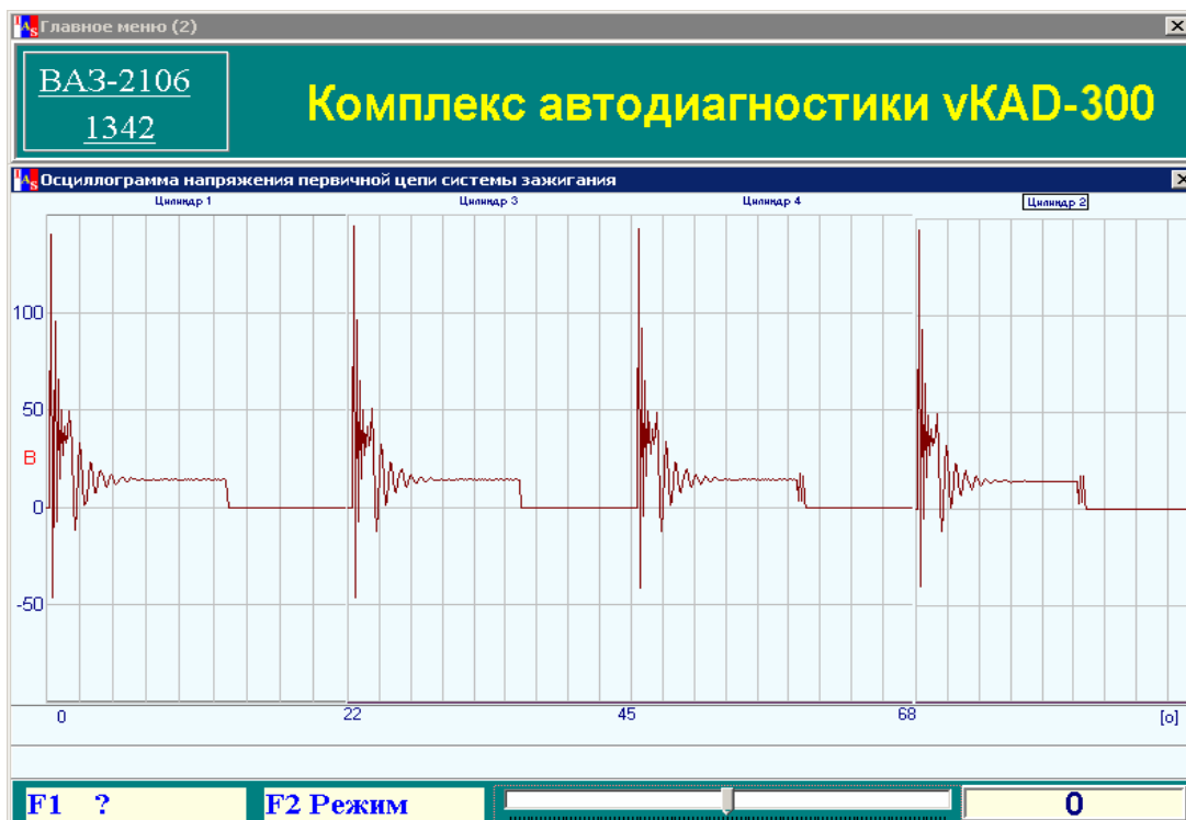
Рис. 7.20. Осциллограмма изменения напряжения первичной цепи системы зажигания
