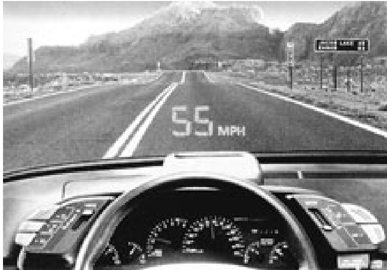
Рис. 2.17. Вид через ветровое стекло автомобиля с HUD. Модель Pontiac Bonneville SSEi
