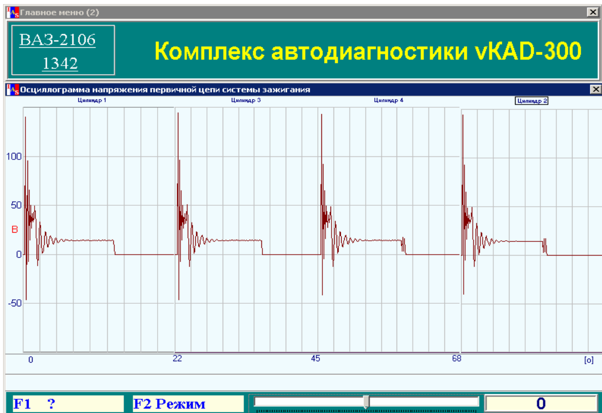
Рис. 2.41. Осциллограмма изменения напряжения первичной цепи системы зажигания
