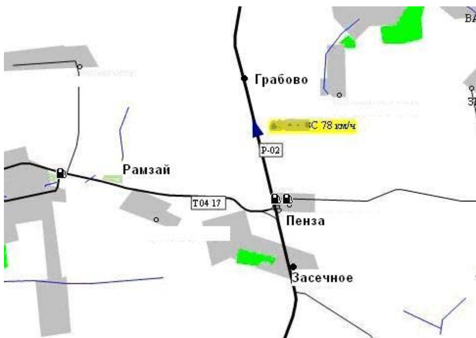
Рис. 6.15. Схема сигнализирования диспетчеру о превышении разрешенной скорости автомобиля в указанном месте
