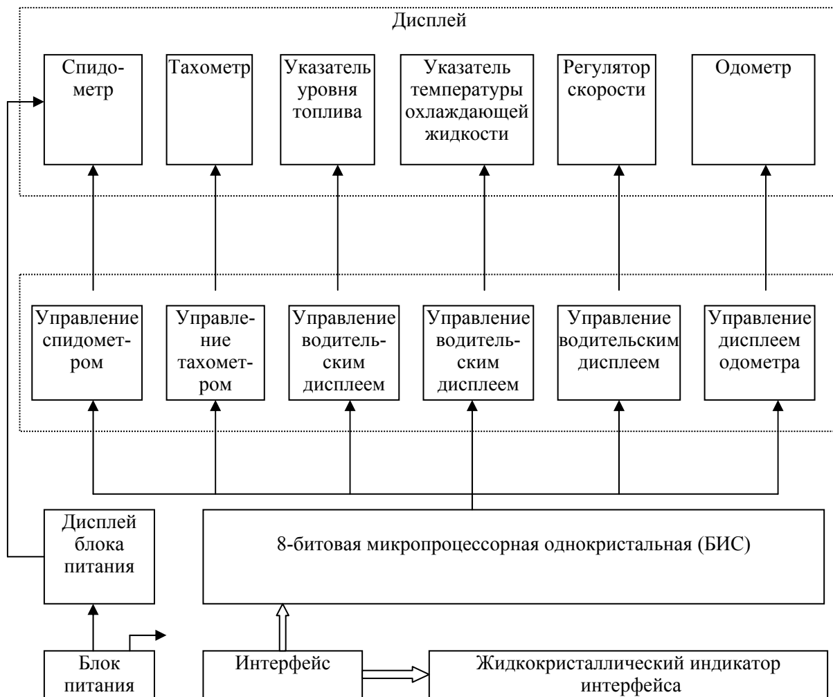
Рис. 2.4. Блок-схема микропроцессорной приборной панели автомобиля «Soarer»
