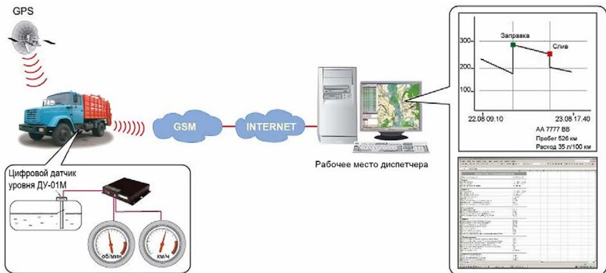
Рис. 6.26. Структурная схема работы системы контроля расхода топлива, заливок и сливов транспортными средствами
