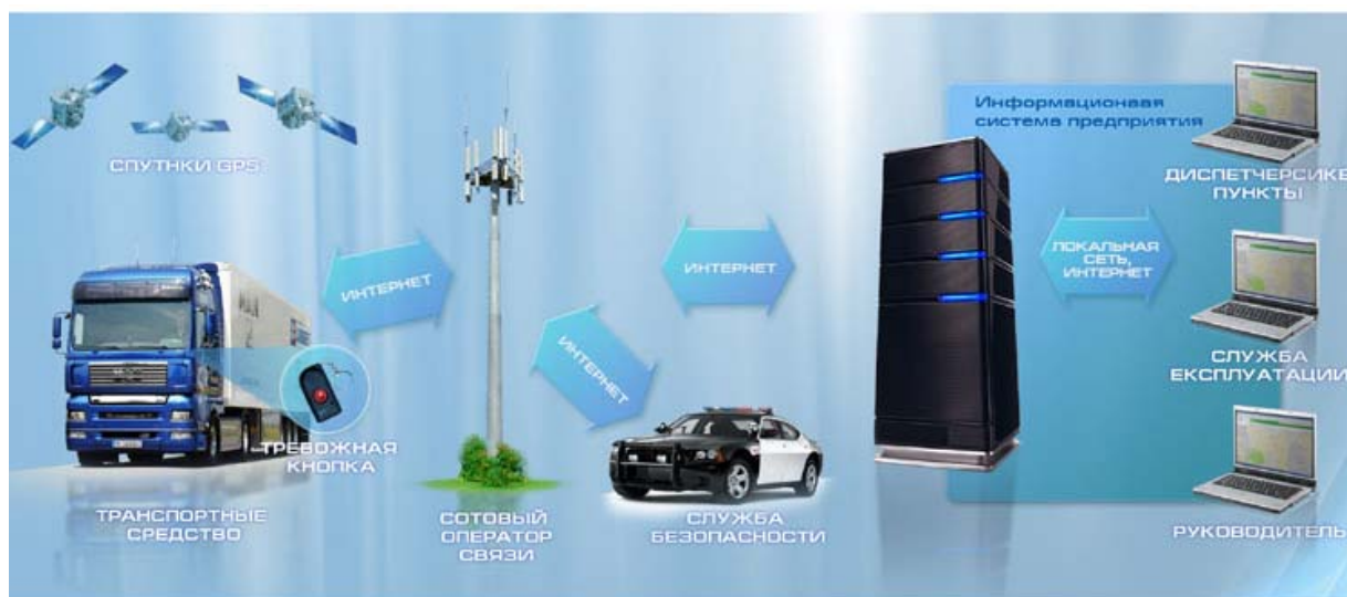
Рис. 6.18. Схема работы системы «GPS-мониторинг транспорта»
