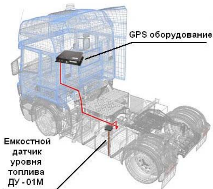
Рис. 6.27. Схема монтажа оборудования GPS-системы на автомобиле
