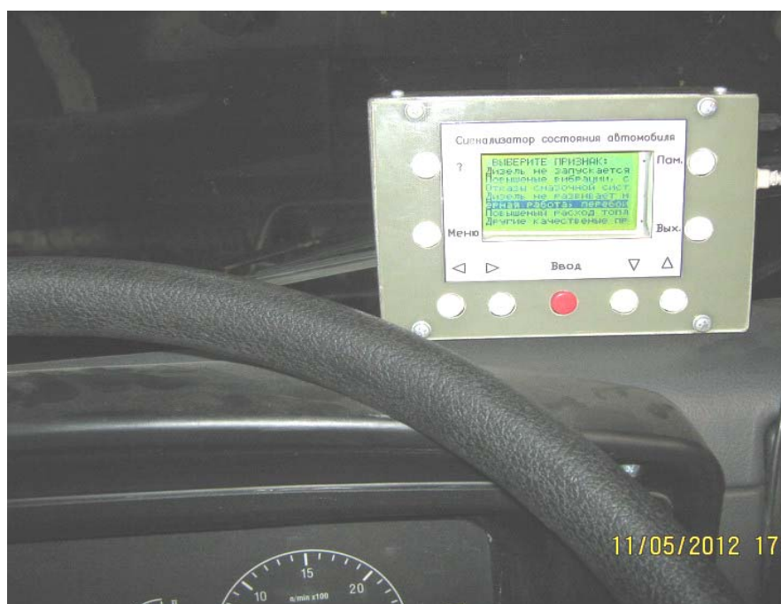
Рис. 2.21. Встроенная система диагностирования автомобиля
