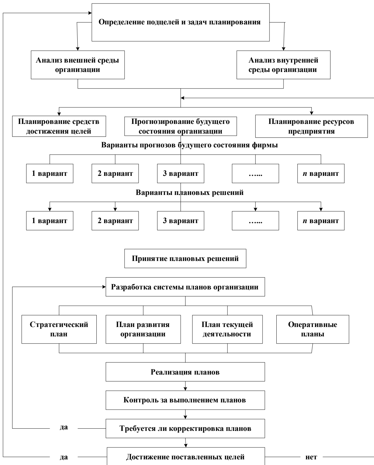
Рис. 3.19. Алгоритм процесса планирования в строительной организации
