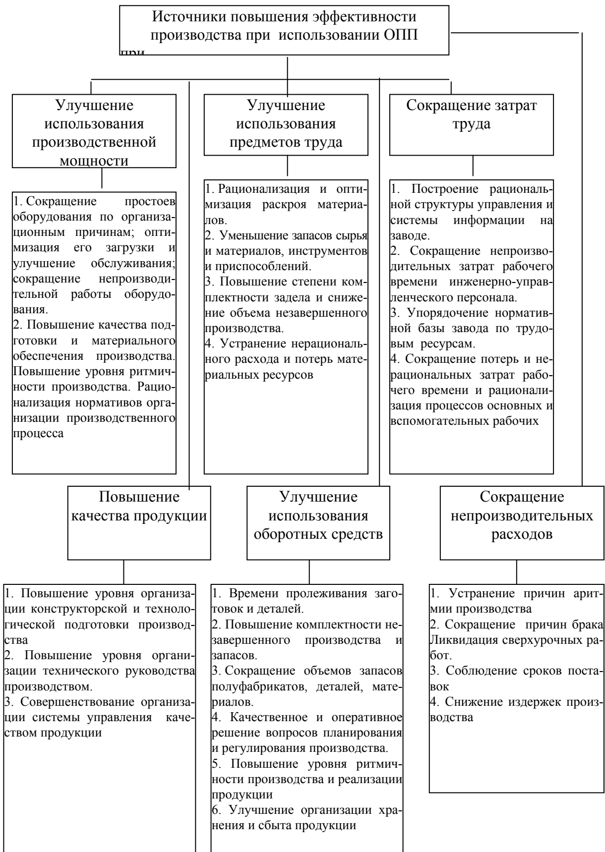
Рис. 6.3. Влияние оперативно-производственного планирования на повышение эффективности производства
