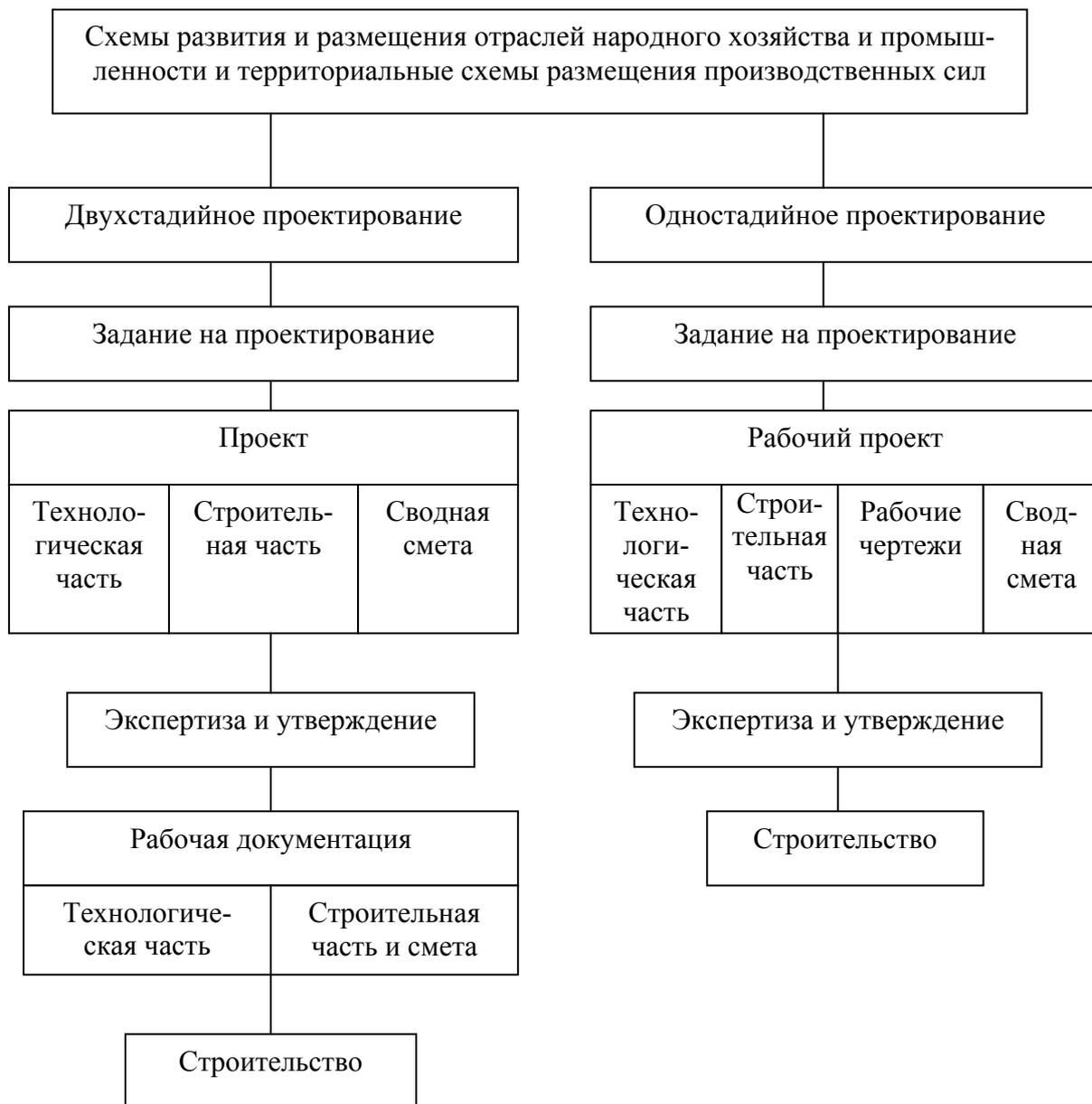
Рис. 4.1. Принципиальная схема стадийности проектирования
