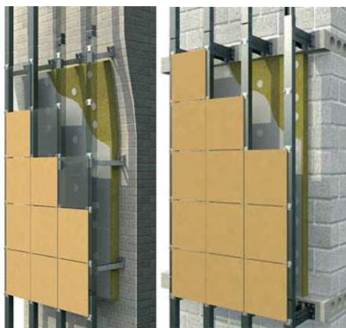
Рис.6.1 Крепление навесных фасадов
