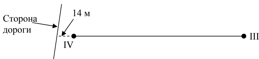
Рис. 35. Схема определения положения стороны дороги способом створов
