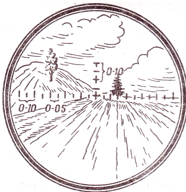
Рис. 21. Измерение углов биноклем
