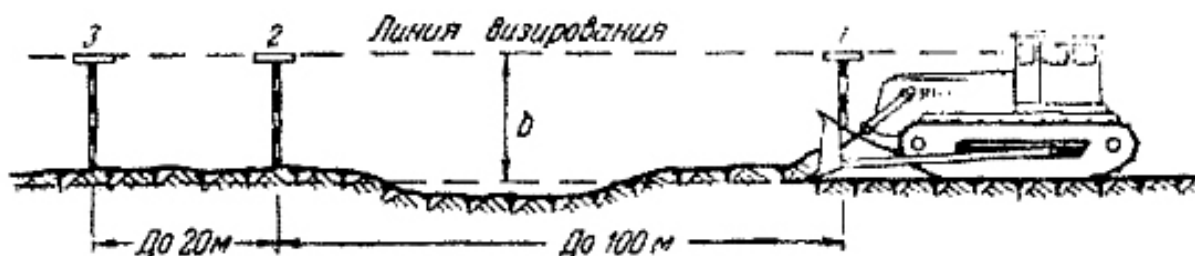
Рис. 36. Схема контроля послойной отсыпки бульдозером
