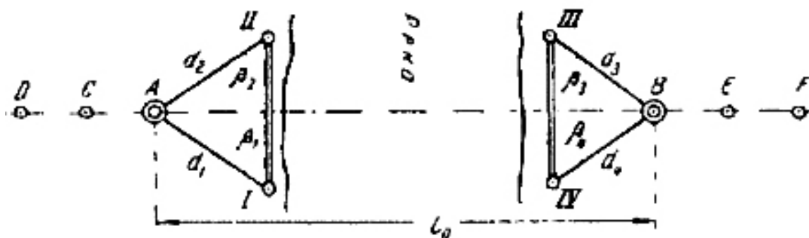
Рис. 48. Схема выноса и закрепления оси мостового перехода
